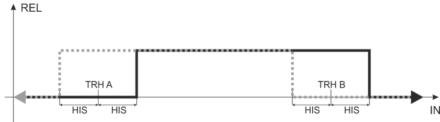
Rysunek 9. Charakterystyka działania wyjść przekaźnikowych przetwornika w przypadku dwóch progów (opcja 5-uAr2 )
